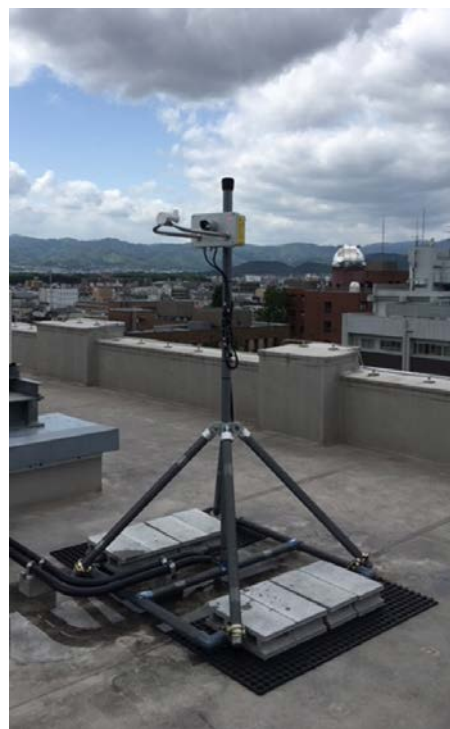
図 1 理学部 1 号館屋上設置のレーザ式降水粒径速度分布測定装置
