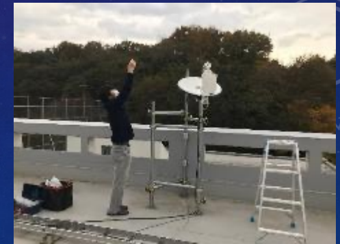
図2 信楽MU観測所設置の雨滴鉛直分布プロファイラ(マイクロレインレーダ)
