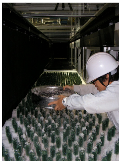
図7 樹木模型内への雪の充填作業 （植被率 7.0%） （防災科学技術研究所新庄雪氷環境実験所）
