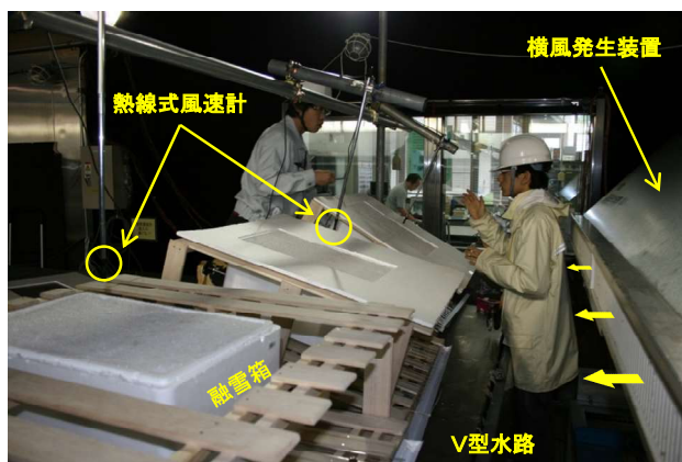
図5 融雪実験装置と横風発生装置 (防災科学技術研究所新庄雪氷環境実験所)
