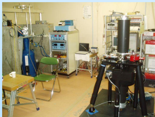
南極昭和基地での絶対重力測定(右)と超伝導重力観測(左)。
